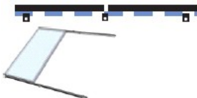
Figura 14. Esquema de 2 coletores e diagrama de distâncias entre pontos de fixação.
