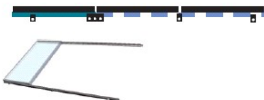
Figura 15. Esquema de 3 coletores e diagrama de distâncias entre pontos de fixação.
